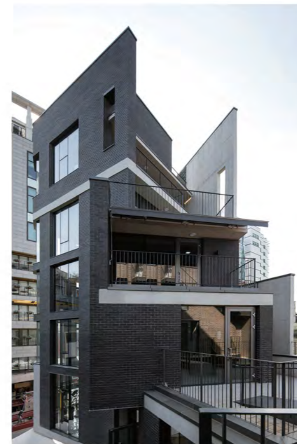
외부 공간을 최대한 확보할 목적으로 수직코어를 도로의 전면에 배치하고 곡선 형태의 각종 평면을 법적 제한선을 비껴가며 쌓아올린 결과, 각종의 테라스가 위치한 복층은 활기찬 외관을 형성한다. With this intention to secure maximum space, the vertical core was placed at the front of the road and the floor area was piled up in a curved form while staying close to the legal limits.
